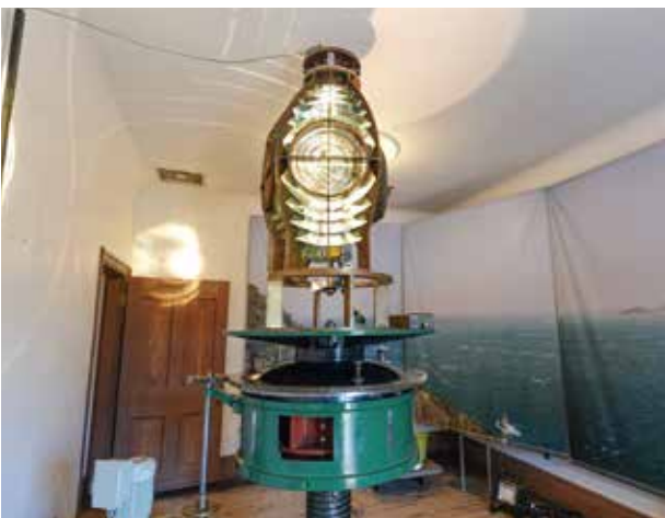
写真8 再稼働した旧神島灯台四等閃光レンズ（※）
