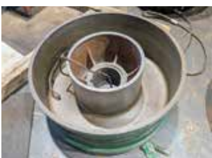
写真3 旧神島灯台回転機械の水銀外槽（※）
