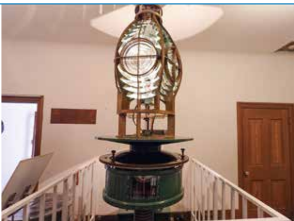
写真1 菅島燈台附属官舎内で動態展示されている旧神島灯台四等閃光レンズ
