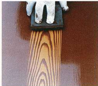
11 かまぼこ形の道具を回転させながら板目を出しているところ
