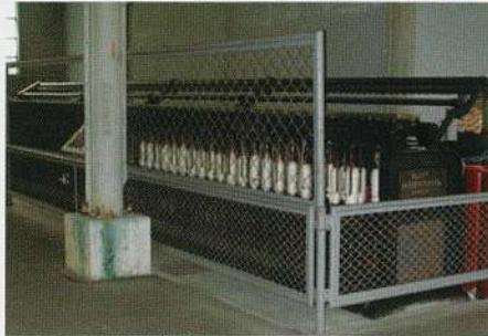
写真7 粗紡機（プラット社 1896年製）
