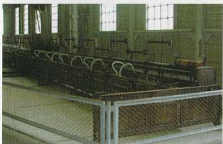
写真9 ミュール精紡機（ハルトマン社 1909年製）
