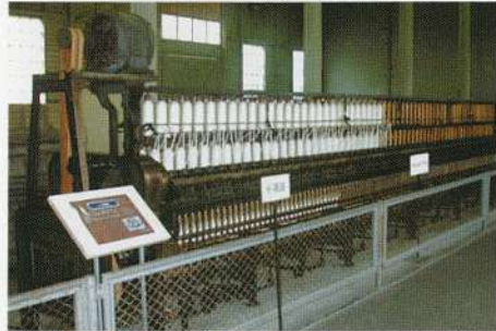
写真8 リング精紡機（プラット社 1893年製）
