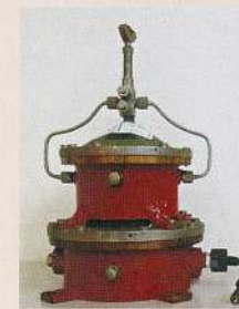
点灯に使用されるアセチレンガス灯器
