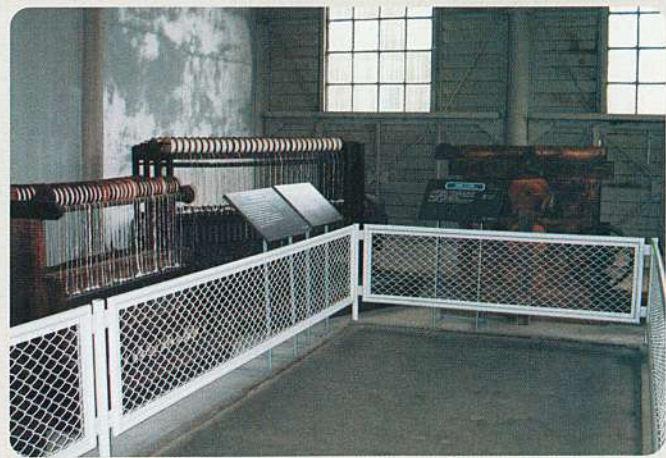
写真2 機械館での展示 左から手回し式ガラ紡、水車式ガラ紡、打綿機（ガラ紡に供給する撚子となる綿を打つ機械）
