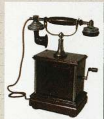
デルビル甲号磁石式電話機(新型) 交換室の様子(大正時代)
